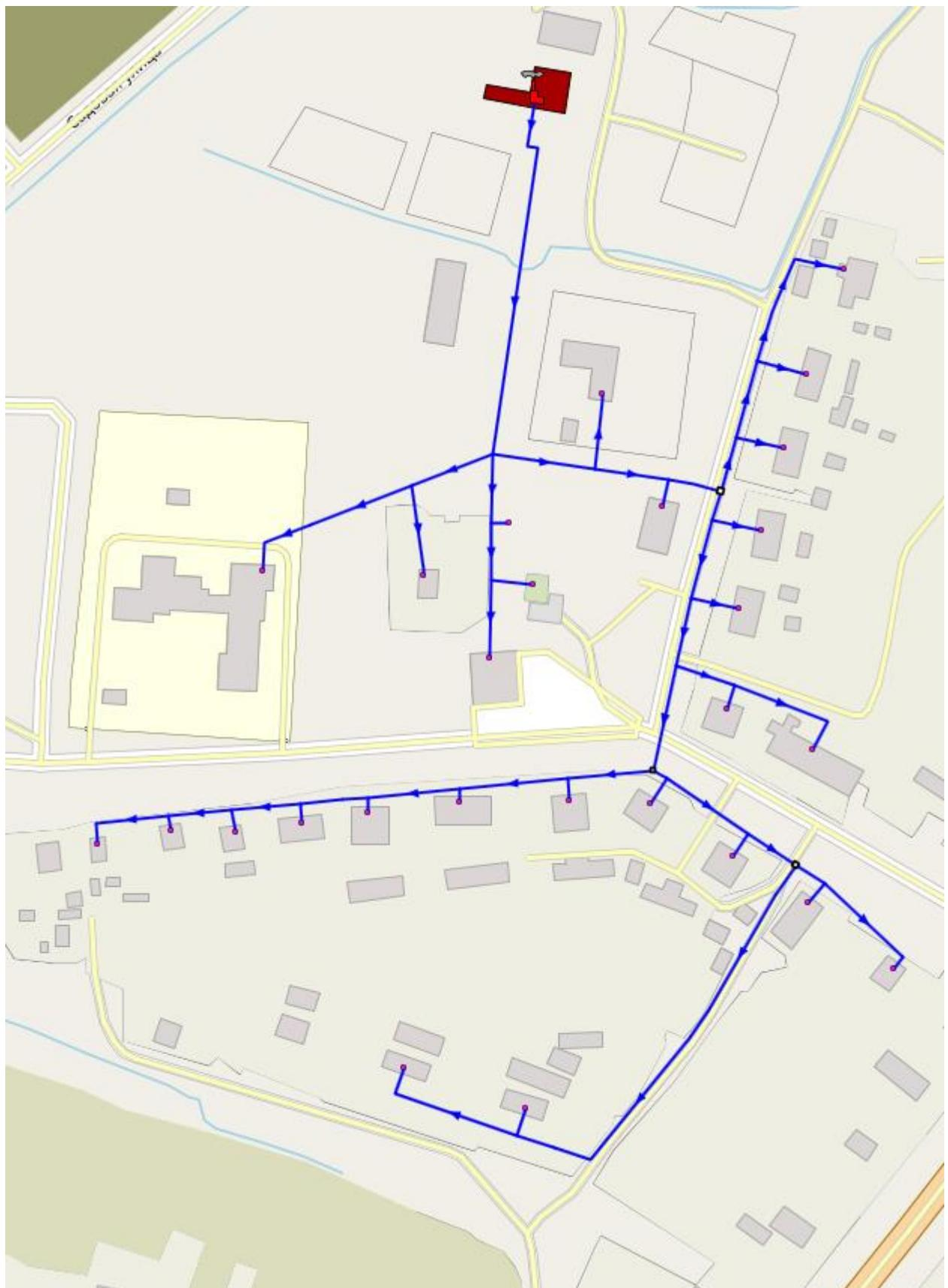
**Рисунок 7 – Схема тепловой сети от котельной д. Волково**
