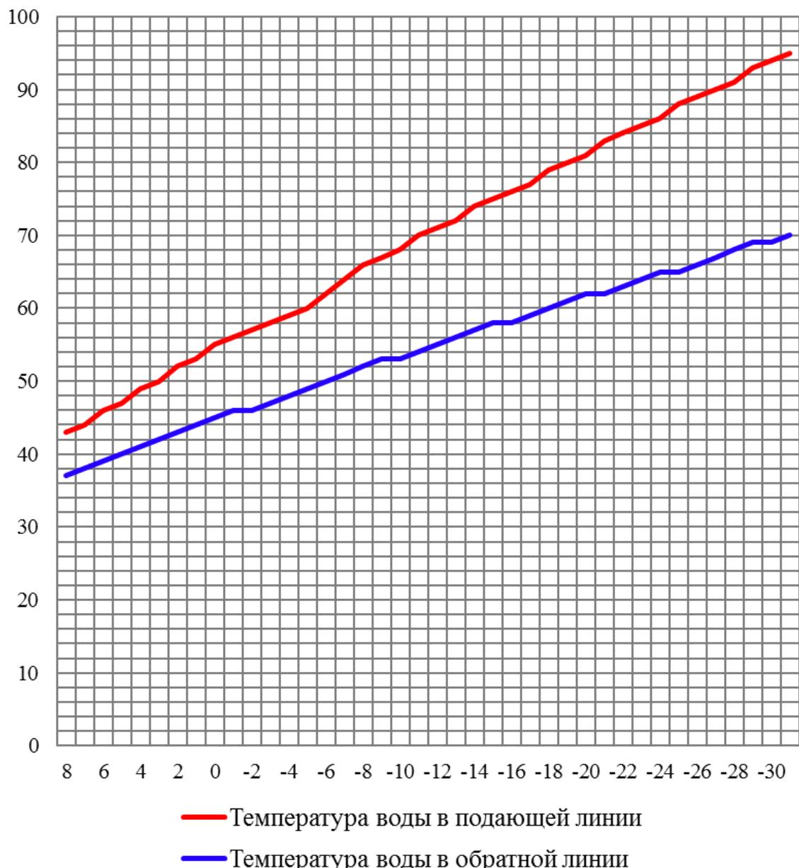
**Рисунок 8 – Графическое представление температурного графика**
