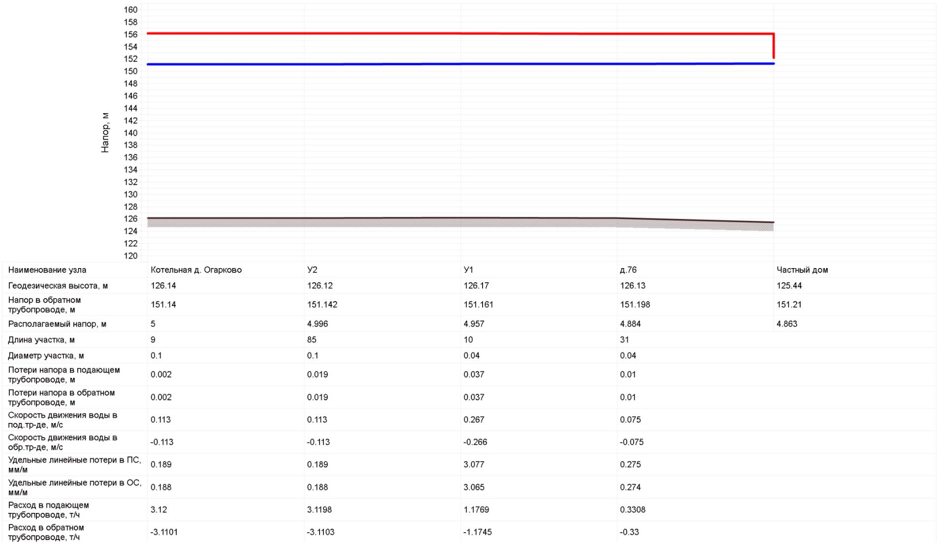
**Рисунок 12 – Пьезометрический график от котельной д. Огарково**
