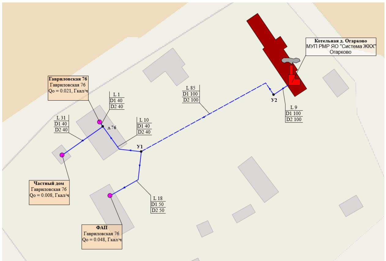
**Рисунок 5 – Схема тепловой сети от котельной д. Огарково**
