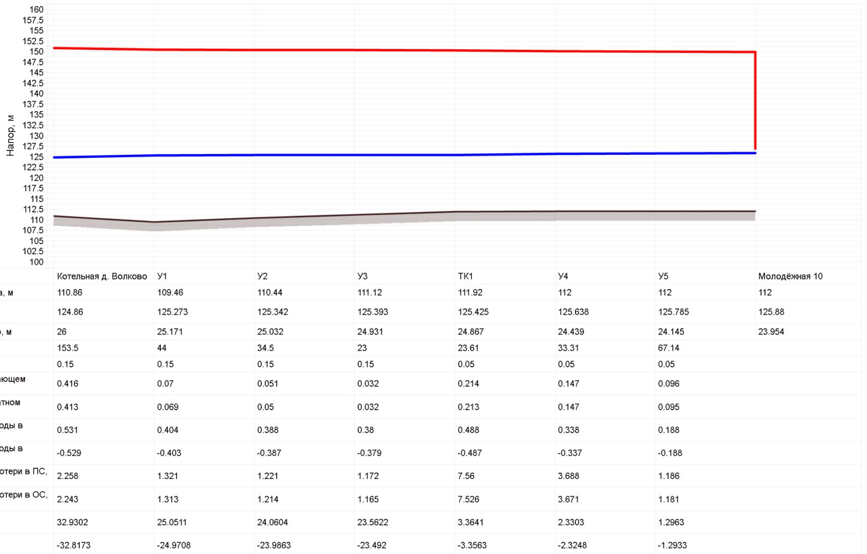
Рисунок 14 – Пьезометрический график от котельной д. Волково
