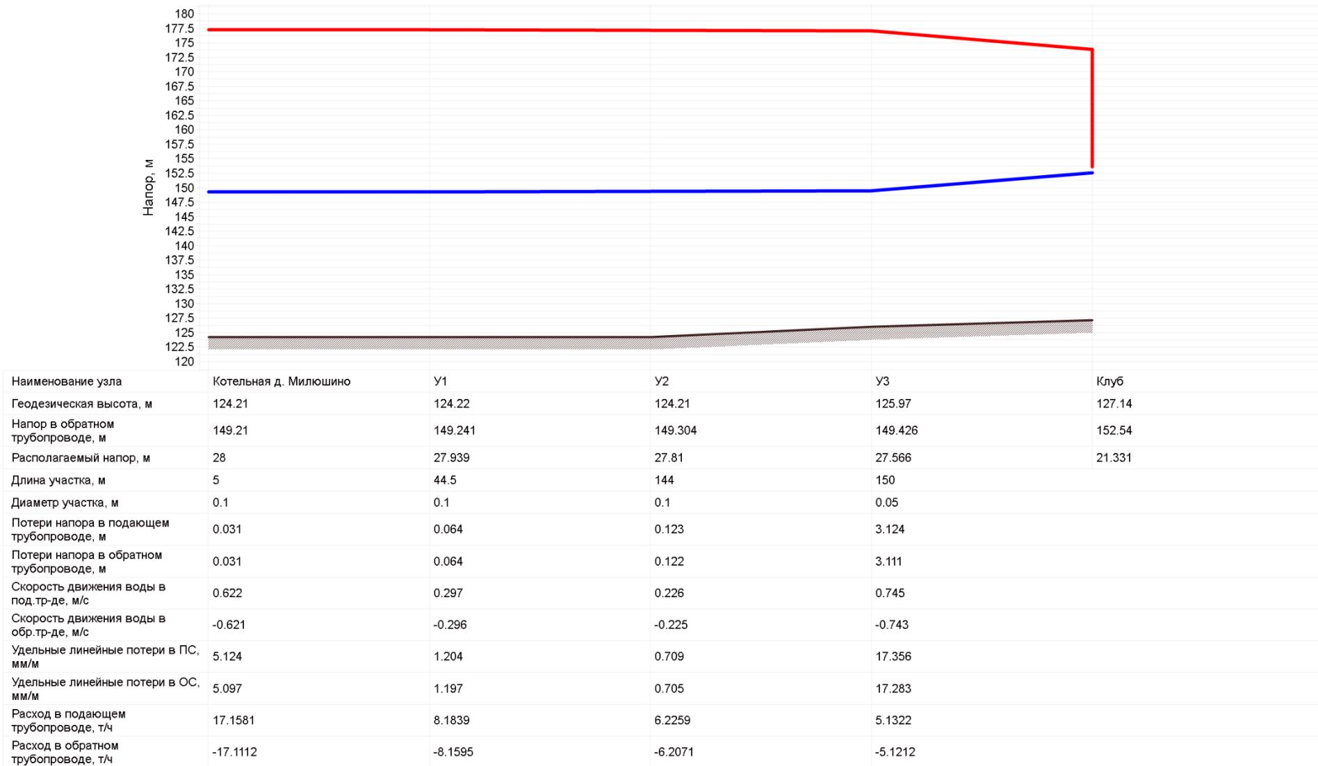
**Рисунок 13 – Пьезометрический график от котельной д. Милюшино**
